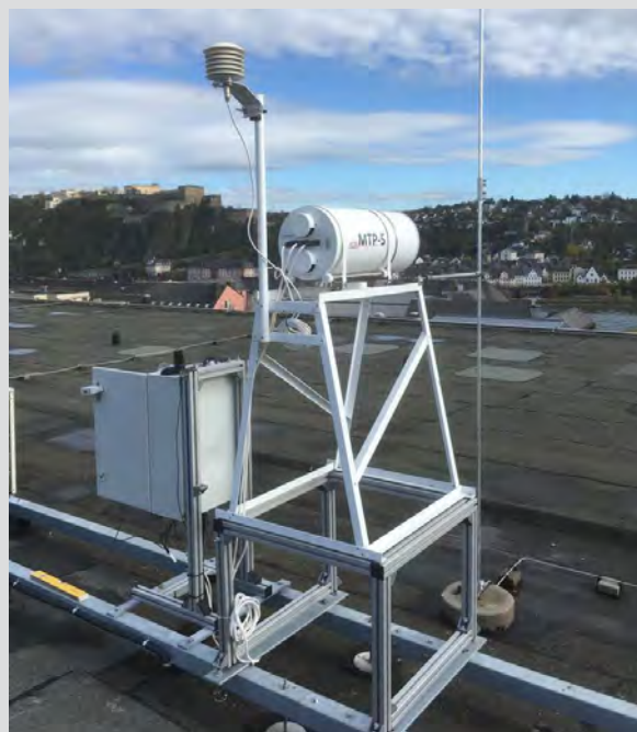
Das neue Mikrowellenradiometer steht auf dem Dach des Hauptjustizgebäudes in Koblenz. Es misst die von den Sauerstoffmolekülen der Atmosphäre emittierte Mikrowellenstrahlung.
