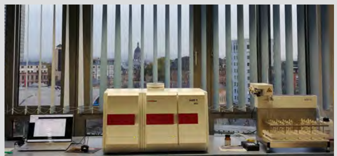
Mit dem AOX-Analysator werden Oberflächen- und Abwasserproben auf Spuren von halogenhaltigen organischen Verbindungen untersucht.
